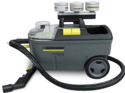
Das Sprühextraktionsmodul SXM 30 C wird eingesetzt, um Dekontaminationsmittel direkt auf die kontaminierte Oberfläche aufzusprühen. Durch Aufsprühen des Dekontaminationsmittels bei gleichzeitigem Absaugen zurück in den integrierten Abwassertank wird die Kontamination gründlich von der Oberfläche entfernt. Das SXM 30 C kann mit drei Aktivkohlefiltern ausgestattet werden, die sehr einfach ausgetauscht werden können, um eine Kontaminationsverschleppung zu verhindern.
